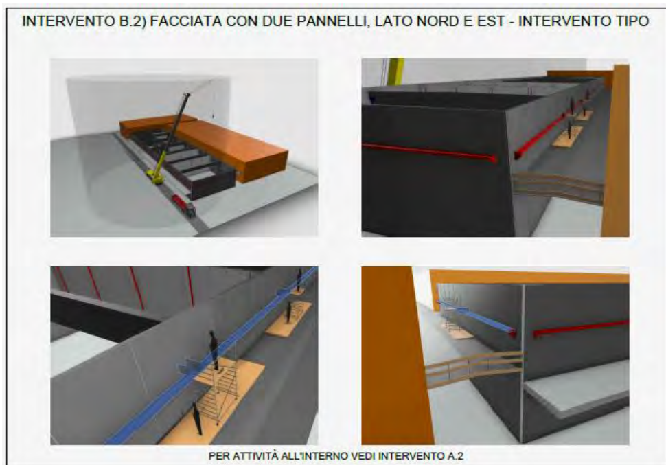
Modello BIM, modalità di esecuzione delle attività all'esterno
