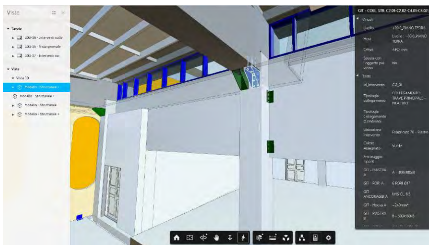
Interrogazione degli elementi in progetto e lista delle loro proprietà
