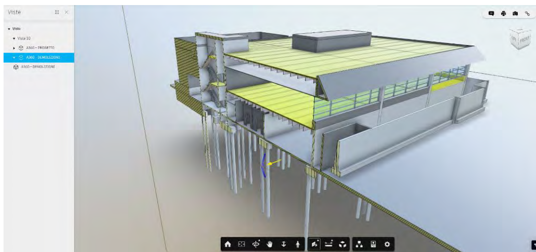
Modello BIM, sezione "dinamica" trasversale del fabbricato con evidenza delle parti oggetto di demolizione
